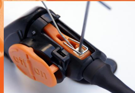
9 - Si l'essai est concluant, démonter le câble de commande et l'arrêt de gaine, et faire ressortir les 3 fils électriques à travers la gaine tressée, à 6 cm du bord de celle-ci.
