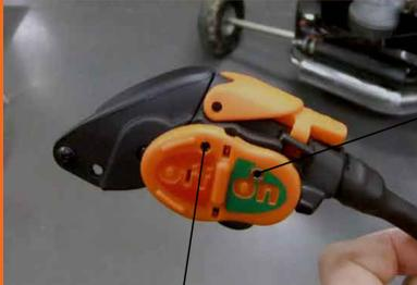
20. Il faut mettre de gros fils et de grosses cosses au bout des fils Cameleon, car les vibrations pourraient casser de petits sertissages. Soudez et mettez une gaine thermo.
