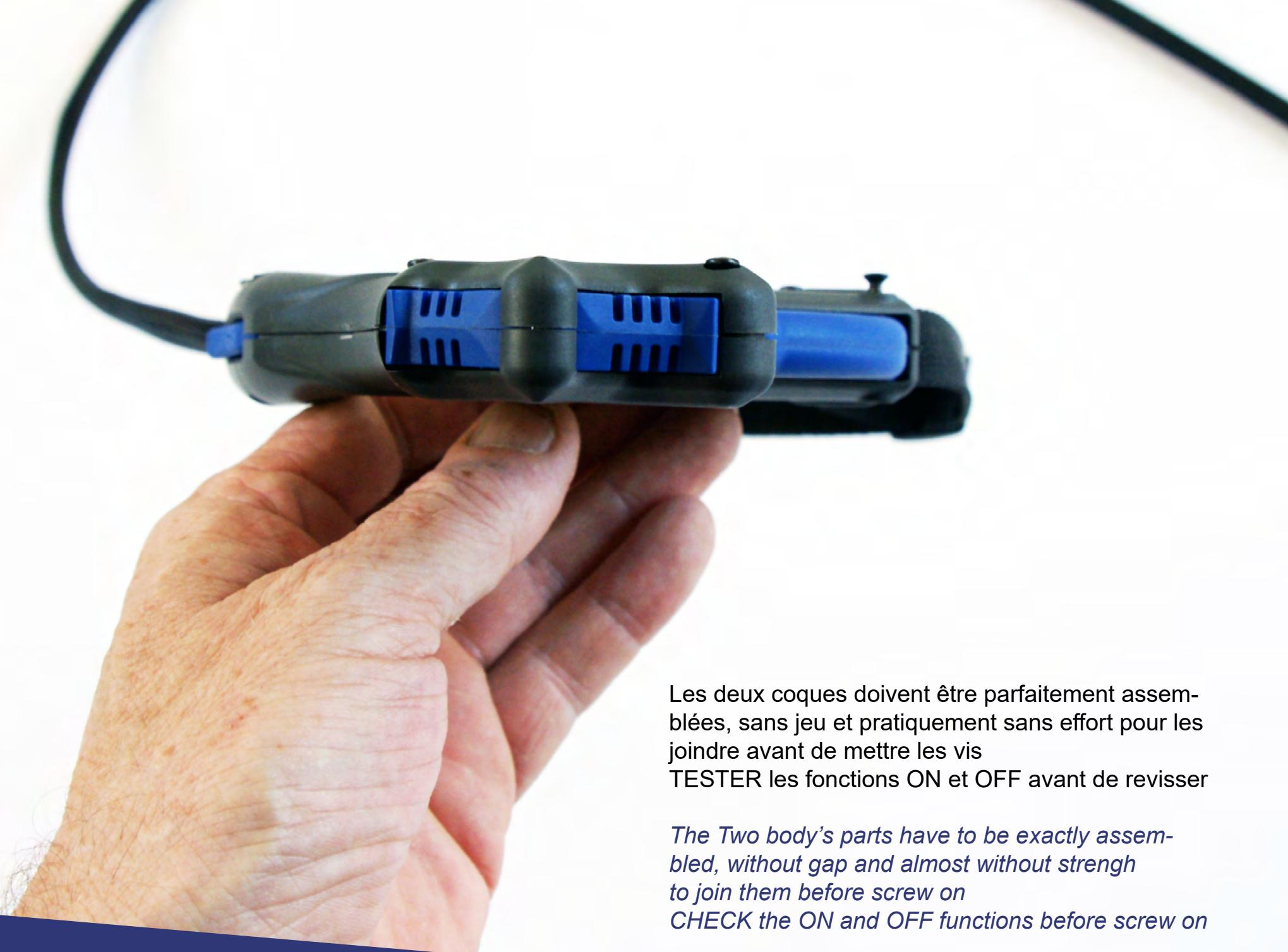
Les deux coques doivent être parfaitement assemblées, sans jeu et pratiquement sans effort pour les joindre avant de mettre les vis
