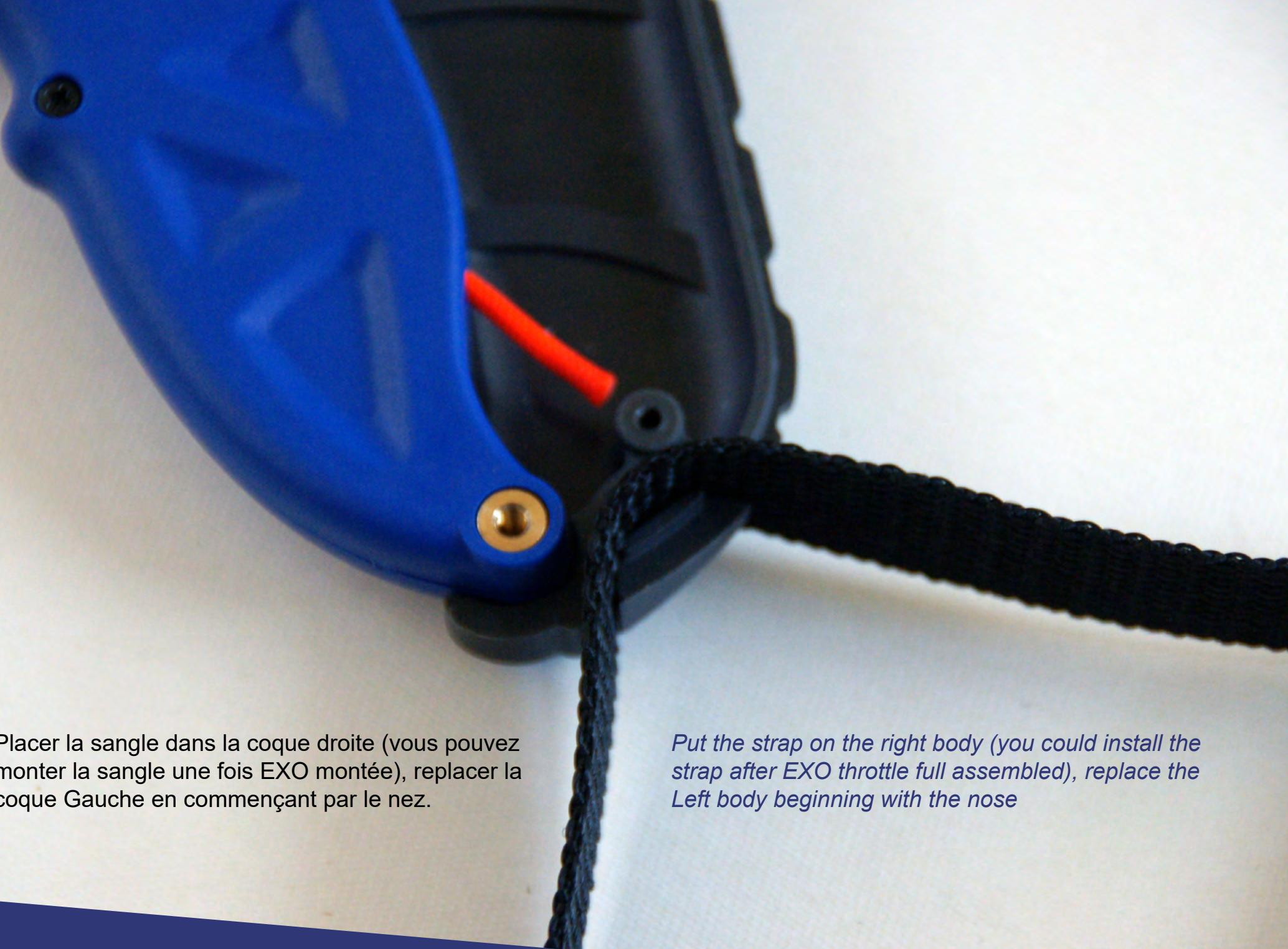
Placer la sangle dans la coque droite (vous pouvez monter la sangle une fois EXO montée), replacer la coque Gauche en commençant par le nez.
